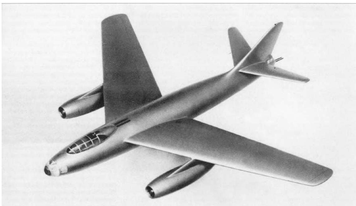
Передняя гермокабина имела панорамное остекление, а так же бронирование в пределах 15 мм. Хвостовая была защищена бронестеклом толщиной 120 мм. Два двигателя (АМРД-02 Микулина или ТР-3 Люльки) были расположены в пилонах впереди-снизу крыла. В
