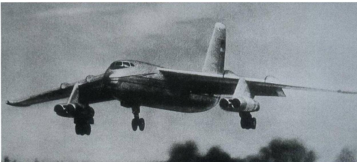
Второй полет (на 20 минут) самолёт выполнил 4-го сентября. Машина была очень легка и послушна в управлении. После доработок скорость на высоте 4800 метров составила 920 км/ч, а на высоте 8300 метров она поднялась до 800 км/ч. Посадочная скорость уменьшилась с 208 до 200 км/ч. Существенно возросла максимальная дальность полёта. Теперь она могла составлять от 2000 до 2300 км. При таких характеристиках немецкий лайнер немного уступал Ту-104, но критичным образом это никак не влияло.
